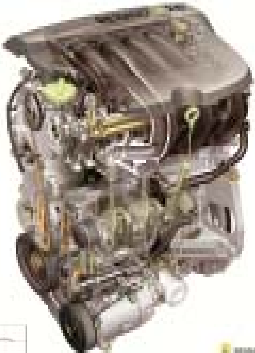
Rys. 1. Przekrój silnika M4R firm Renault i Nissan
