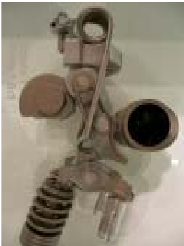
Rys. 18. Układ zmiany skoku zaworu BMW Valvetronic
