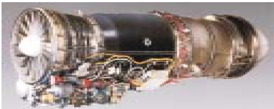
Rys. 26. Dwuprzepływowy silnik turbinowy F404-GE-400 (spręż \pi = 25 , stopień podziału strumienia \mu = 0,34 )
