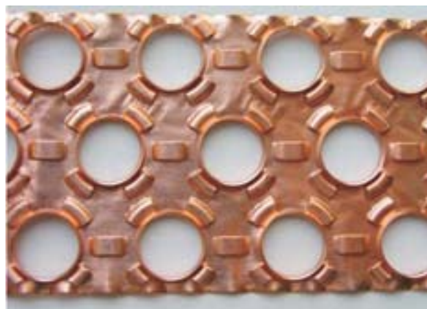
Rys. 3. Widok jednego z żeber tworzących rdzeń chłodnicy mieszanki Fig. 3. View of one of the ribs forming the core of the mixture cooler
