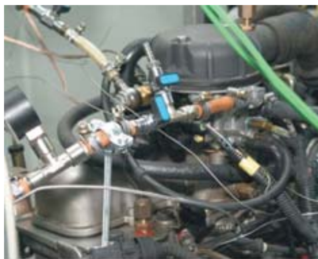
Rys. 6. Elementy układu zasilania silnika ciekłym gazem Fig. 6. Elements of the liquid gas feeding system
