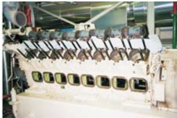
Rys. 6. Kadłub silnika przy zastosowaniu płynu chłodzącego Coolelf Supra po 10 490 godzinach pracy
