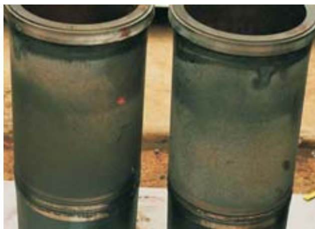
Rys. 8. Tuleje cylindrowe przy zastosowaniu płynu chłodzącego Coolelf Supra po 10 490 godzinach pracy
