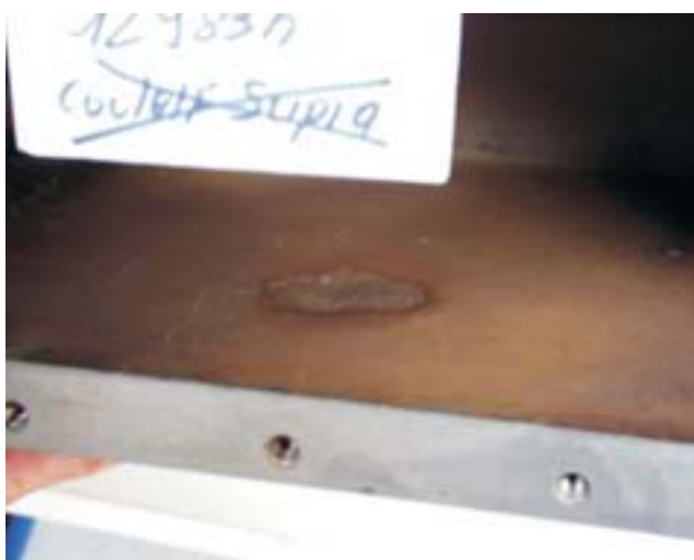
Rys. 9. Aluminiowa osłona wymiennika ciepła przy zastosowaniu konwencjonalnego płynu chłodzącego po 12 980 godzinach pracy
