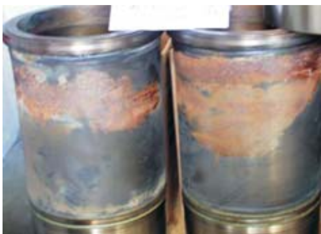
Rys. 7. Tuleje cylindrowe przy zastosowaniu konwencjonalnego płynu chłodzącego po 7080 godzinach pracy
