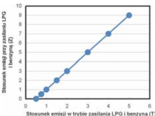
Rys. 3. Stosunek emisji przy zasilaniu LPG i benzyną w funkcji stosunku emisji w trybie zasilania tymi paliwami (założenie: w trybie zasilania LPG emisja w fazie zasilania benzyną wynosi 50% całej wartości)
