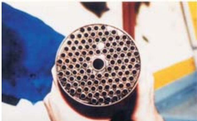
Rys. 3. Ten sam wymiennik ciepła, który został pokazany na rysunku 2, po stosowaniu nowego płynu chłodzącego Coolelf Supra GF NP , całkowicie opartego na technologii organicznej, po 18 miesiącach stosowania
