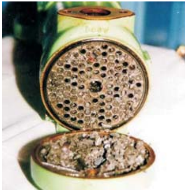
Rys. 2. Czteromegawatowy wymiennik ciepła zablokowany przez osad powstały pod wpływem inhibitorów organicznych zawartych w konwencjonalnym płynie chłodzącym po 18 miesiącach użytkowania
