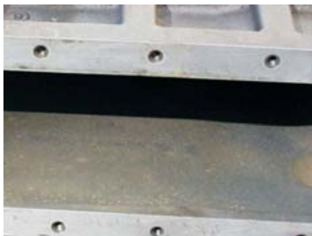
Rys. 10. Aluminiowa osłona wymiennika ciepła przy zastosowaniu płynu chłodzącego Coolelf Supra po 7240 godzinach pracy
