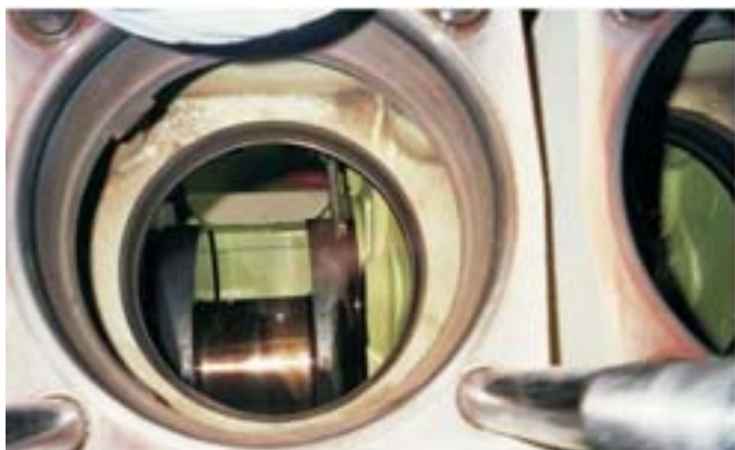
Rys. 6. Kadłub silnika przy zastosowaniu płynu chłodzącego Coolelf Supra po 10 490 godzinach pracy
